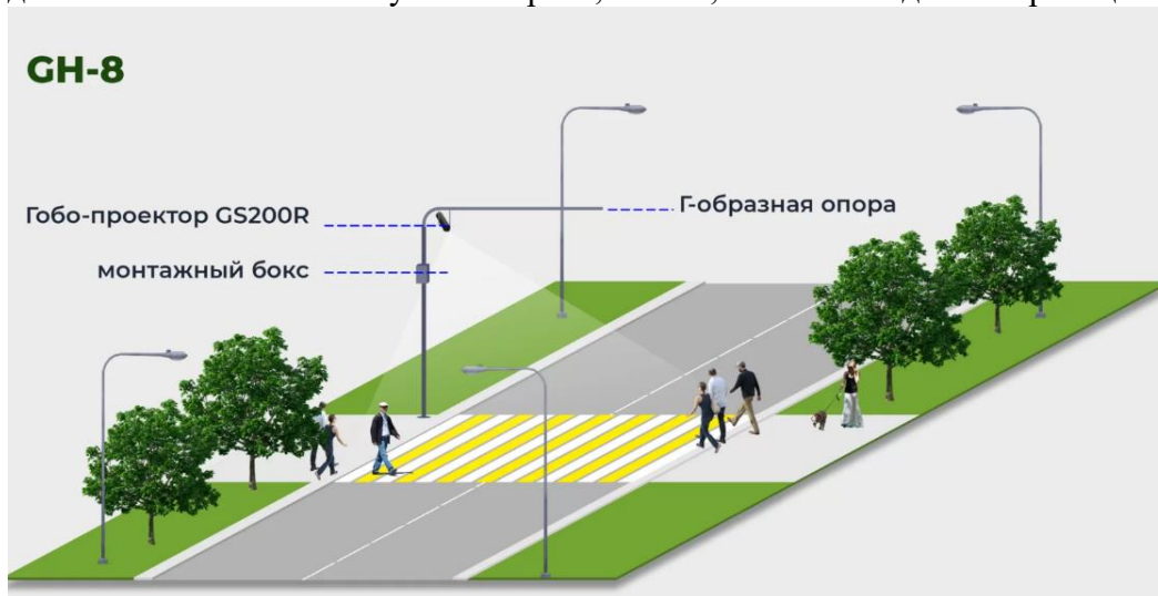
Рис.1. Проекционный пешеходный переход, оснащенный гобо-проектором.
