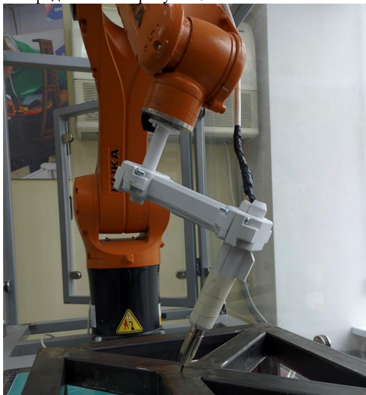
Рис. 5 – Собранное крепление на промышленном роботе
